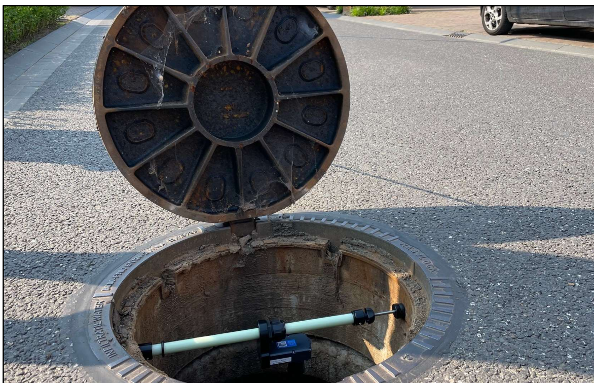
Flowfacts contactloze meet- en communicatiemodule aan een montagestang
