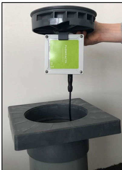
Flowfacts wordt vanuit een klein putje verbonden met het te meten medium.
